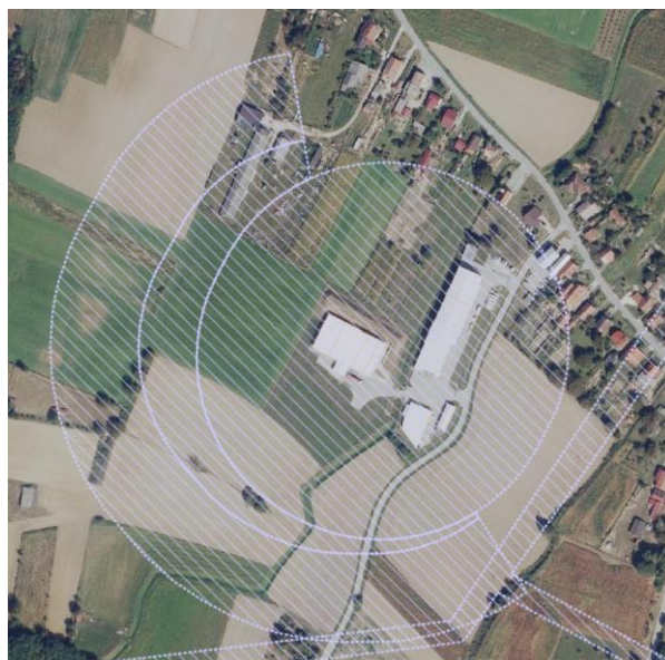
Sigurnosni prostori oko skladišta eksplozivnih tvari u naselju Bakovčica
