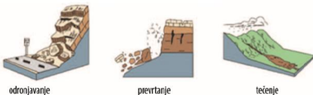
Slika 26. Prikaz osnovnih tipova klizanja prema mehanizmu kretanja
