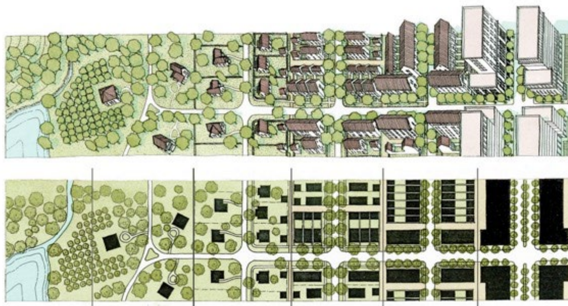
Slika 251 Matrica izgrađenosti (Izvor: Greater Auckland Inc )
